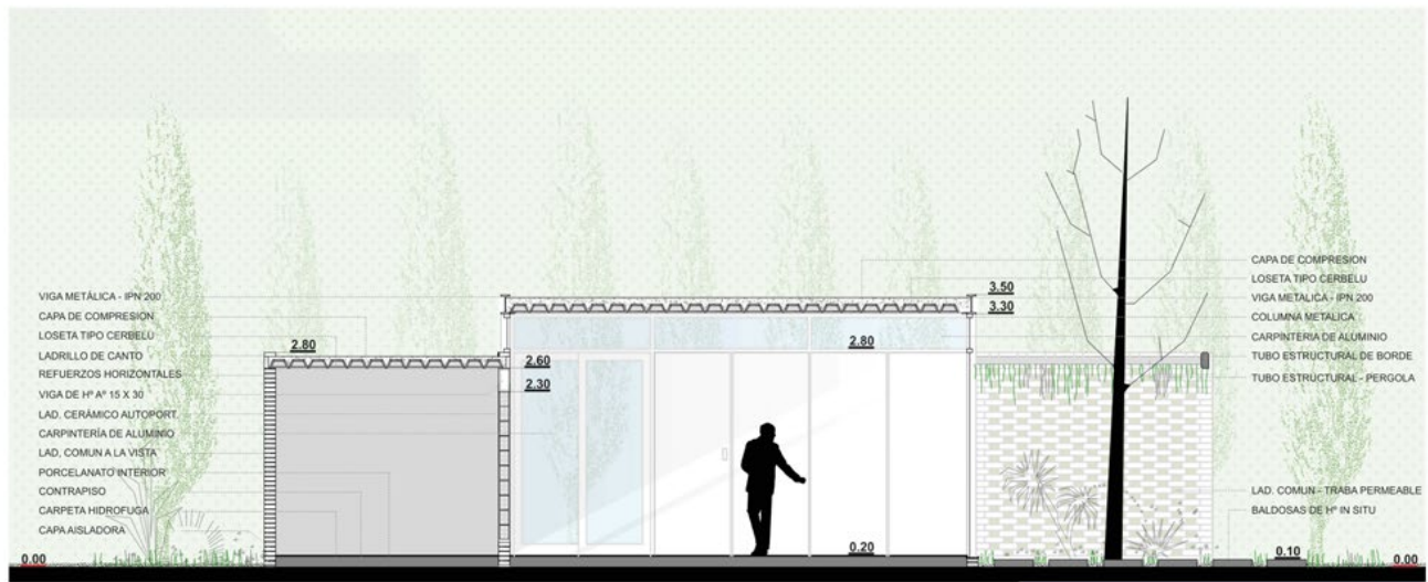
CORTE CONSTRUCTIVO LONGITUDINAL
