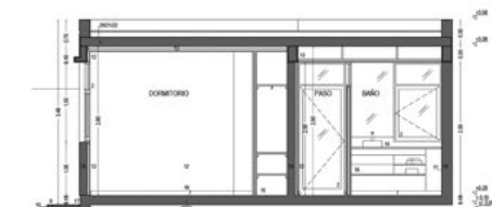
CORTE TRANSVERSAL | MODULO COMPLETO 60 M2
